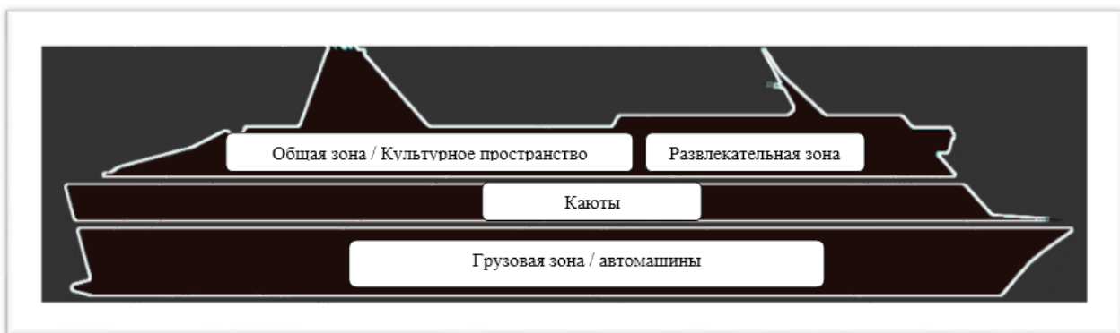
Рис. 6. Укрупнённая схема компоновки зон на морском пароме для Балтийского региона
