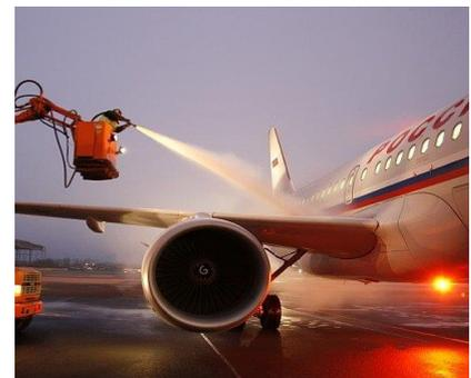
Рис. 1. Противообледенительная обработка самолетов в аэропорту
