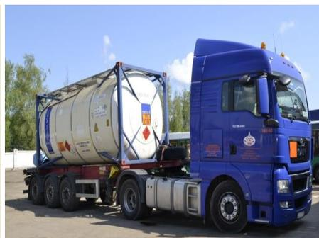
б) танк-контейнер на контейнеровозе Kassbohrer CS
