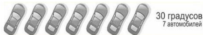
Рис. 5. Принцип размещения автомобилей на парковке под углом 30 градусов
