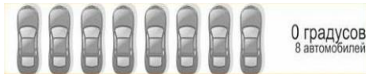
Рис. 4. Принцип размещения автомобилей на парковке под углом 0 градусов
