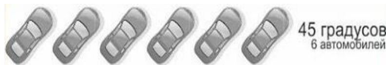
Рис. 6. Принцип размещения автомобилей на парковке под углом 45 градусов
