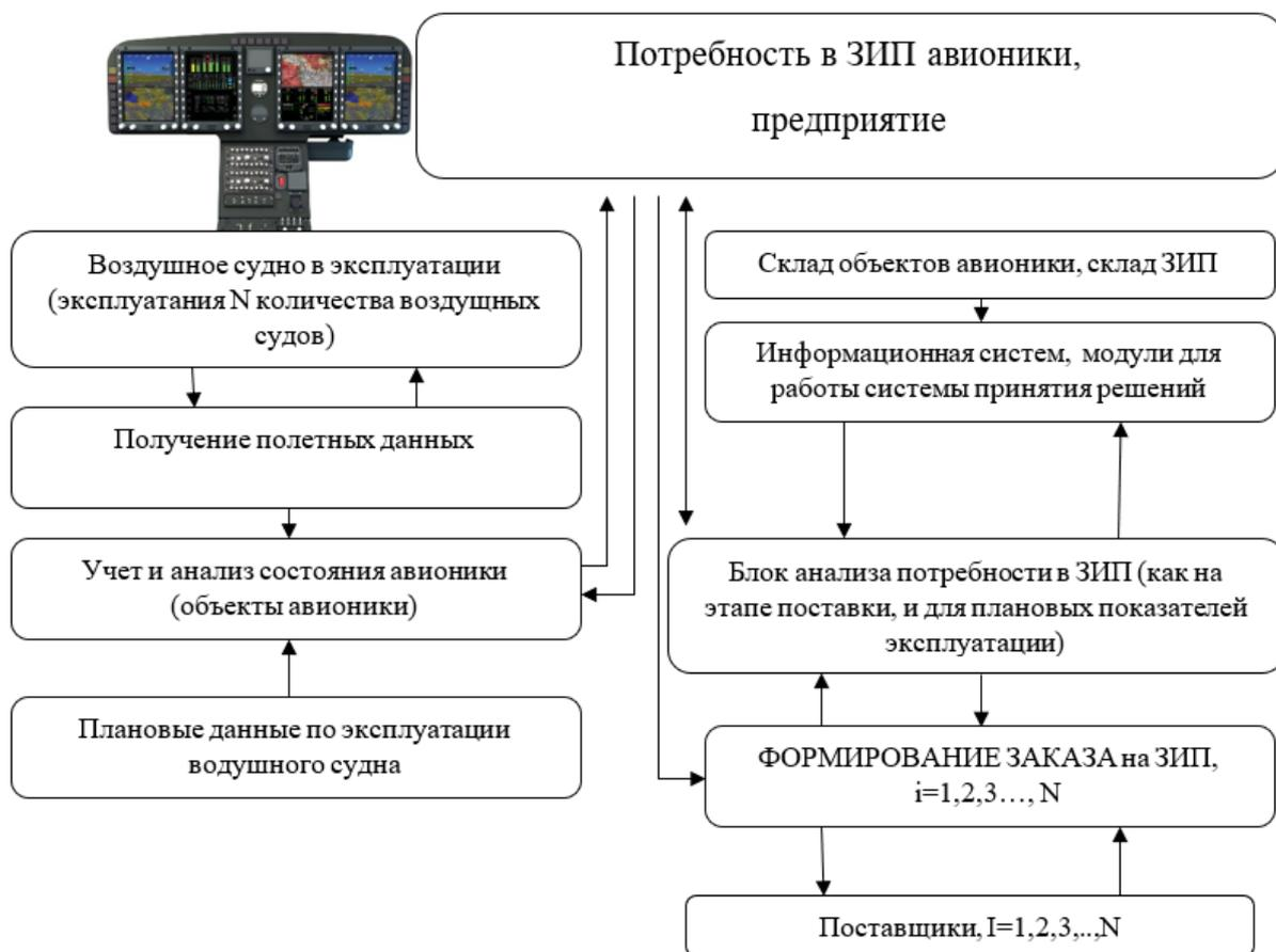
Рис. 2. Схема информационных потоков в логистической системе поставок ЗИП объектов авионики
