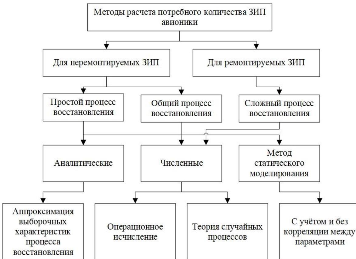
Рис.4. Классификация методов расчета ЗИП, основанная на теории процессов восстановления
