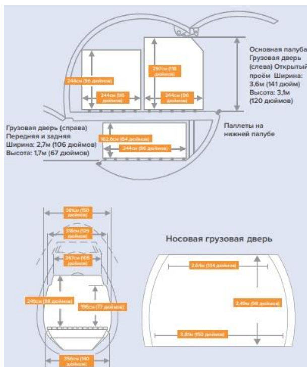
Рис. 3. Размеры грузовых ворот Боинг 747-8F
