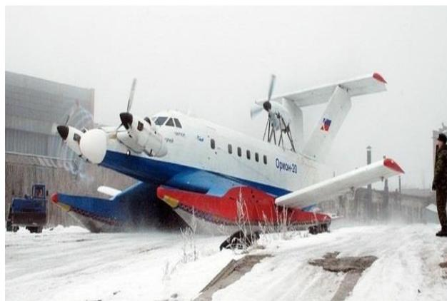
Рис. 17. Экраноплан «Орион-20»
