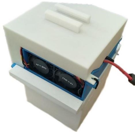
Рис.5. Охлаждающий контейнер с возможностью поддержания заданной температуры
