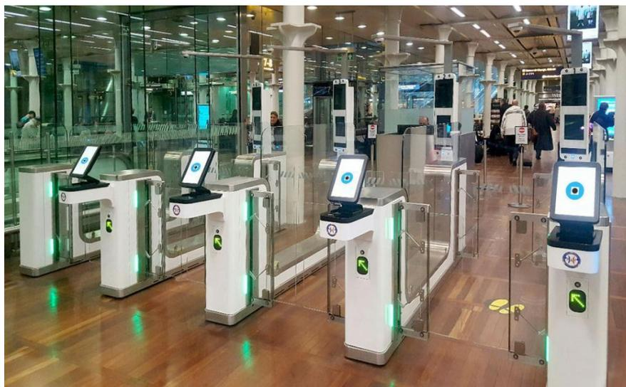
Рис. 4. Стойки контроля биометрических данных
