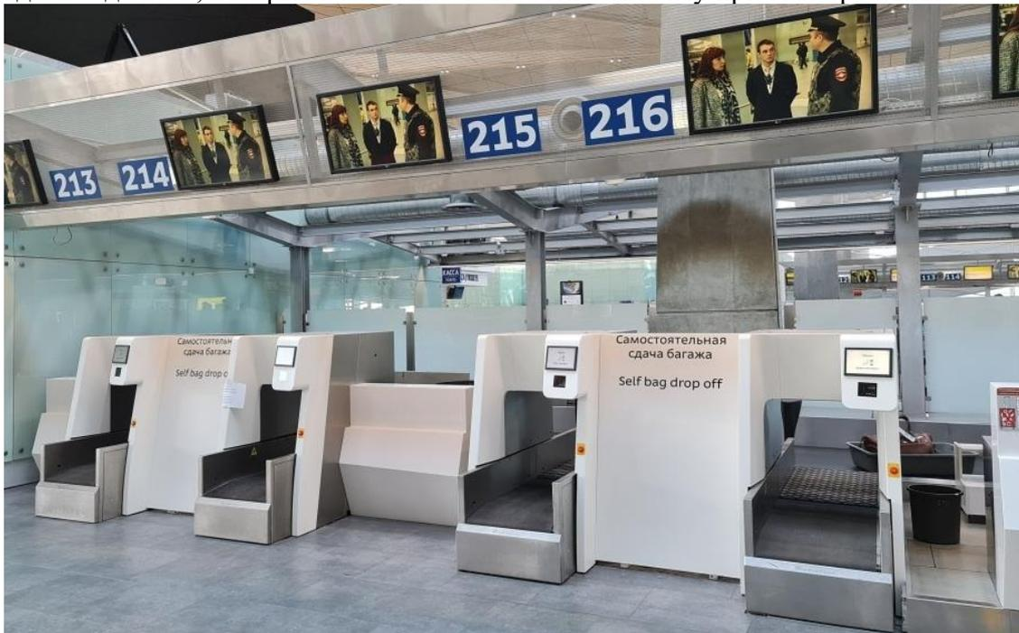
Рис. 2. Киоски самостоятельной сдачи багажа
