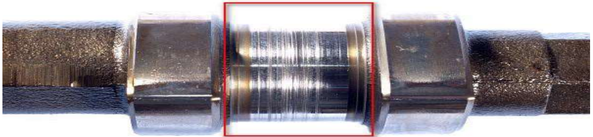
Рис. 3. Задиры на опорной шейке распределительного вала [3]
