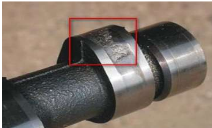
Рис.4. Задиры на рабочей поверхности кулачков [3]
