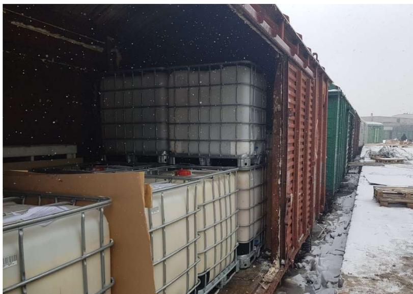
Рис. 6. Загрузка ИВС-контейнеров в 2 яруса в крытый цельнометаллический вагон
