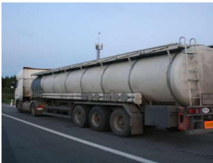
Рис. 5. Цистерна для перевозки ацетона
