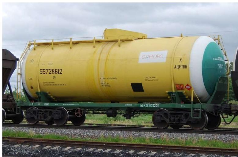
Рис.2. Цистерна для перевозки ацетона
