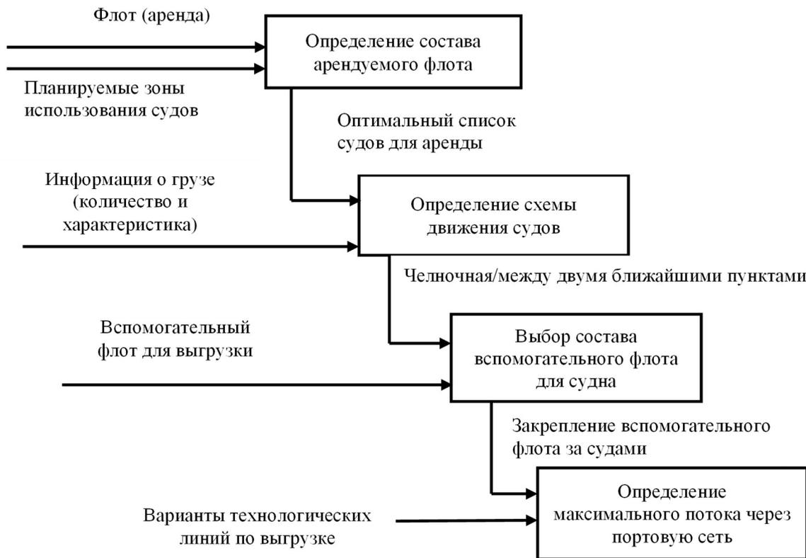
Рис.2. Подпроцессы управления работой флота в малых судоходных компаниях (уровень рейсового планирования)
