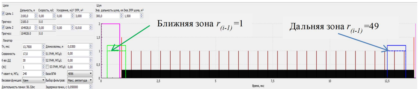
Рис. 1. Ненаблюдаемая задержка сигналов объекта в ближней и дальней слепой зоне при ППИ 14 мкс и частоты (шумы приемника) в каждом дискрете рабочей зоны ППИ
