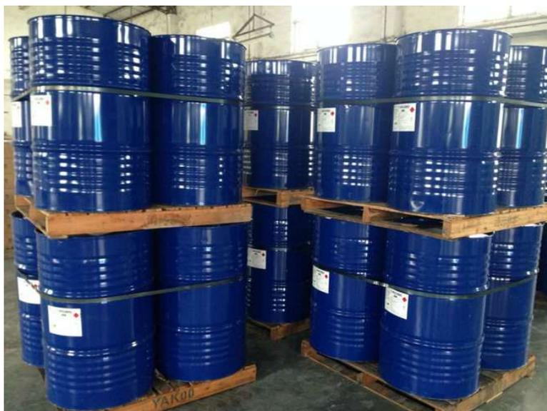
Рис. 3. Бочки для перевозки фенола типа 1A1 на FIN паллете
