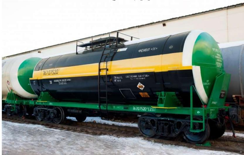
Рис. 2. Цистерна для перевозки фенола модели 15-1603-01-918
