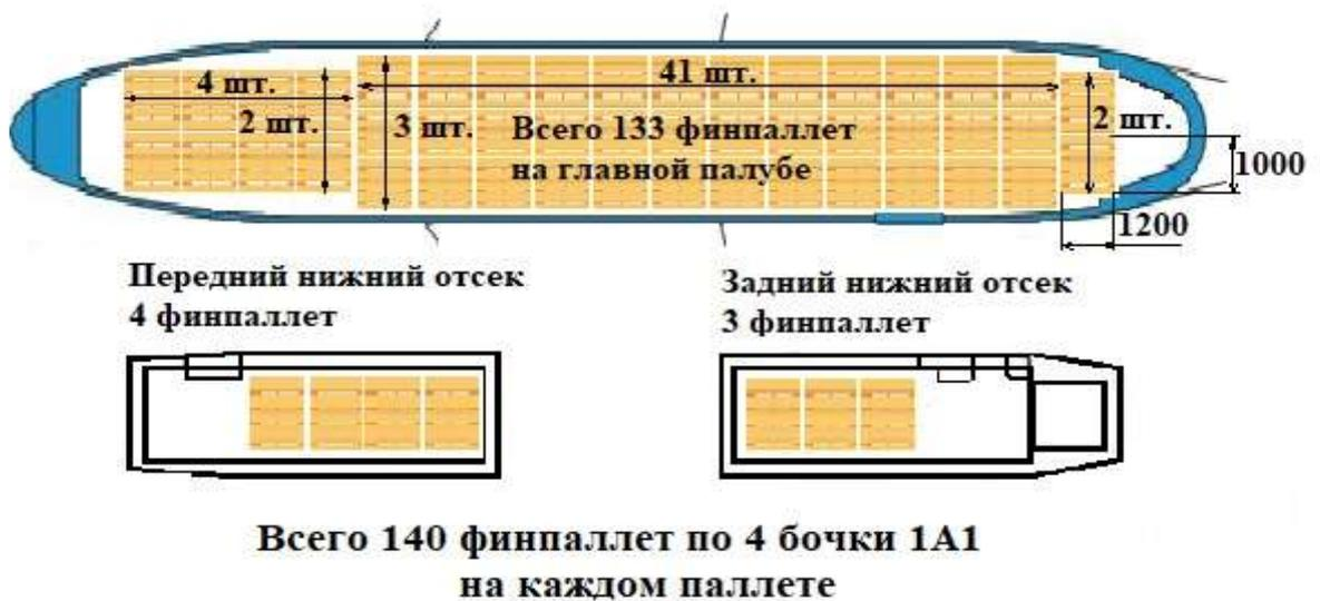
Рис. 7. Схема размещения финпаллет с бочками в грузовых отсеках самолета Boeing 741-8F
