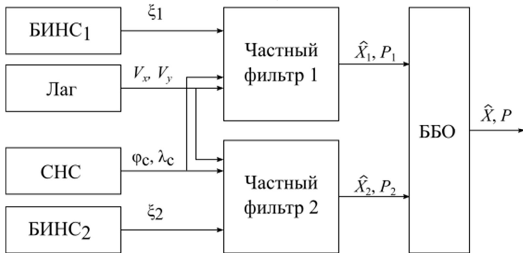
Рис. 2. Схема федеративного фильтра
