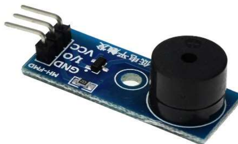
Рис.2. Модуль активного пьезодинамика
