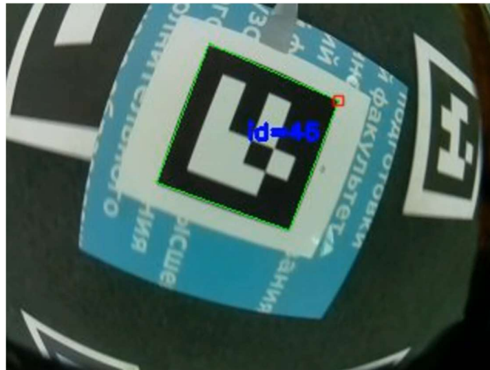
Рис. 5. Изображение с камеры беспилотной авиационной системы непосредственно перед посадкой на движущуюся платформу
