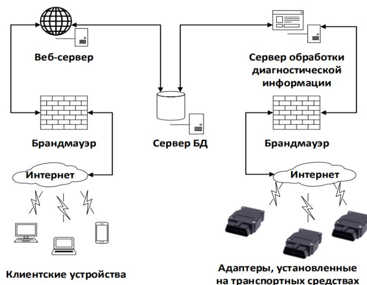
Рис. 1. Схема организации серверной составляющей программно-аппаратного комплекса
