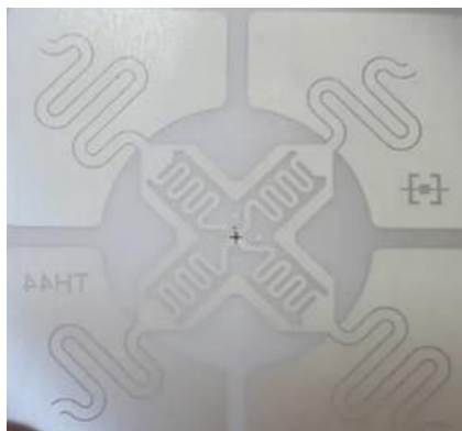
Рис. 2. Визуальное представление идентификационной метки на основе применения технологии радиочастотной идентификации
