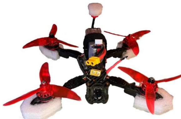
Рис. 5. Практический результат проектирования беспилотной авиационной системы мультироторного типа
