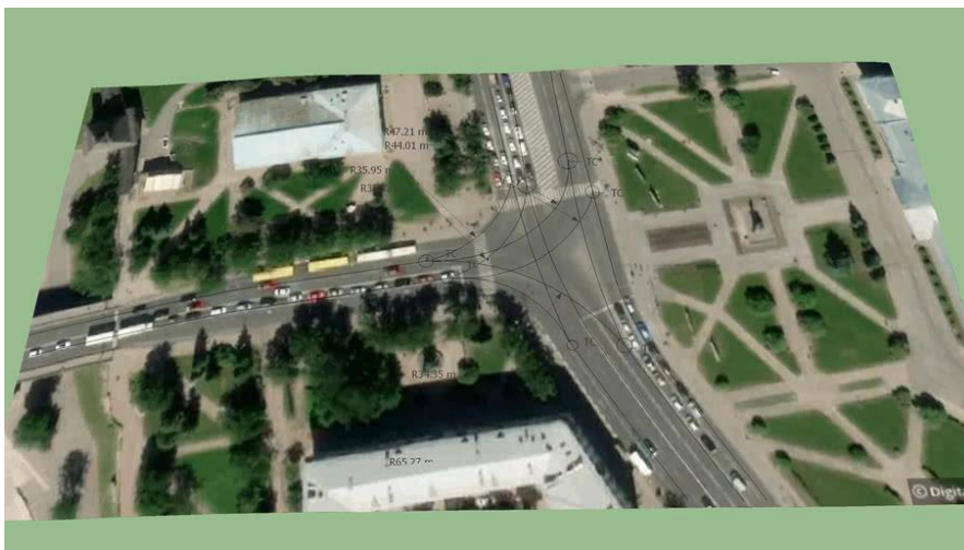
Рис. 1. Пример трехмерной модели перекрестка на основе данных от беспилотной авиационной системы (согласно работам [2,3,4])
