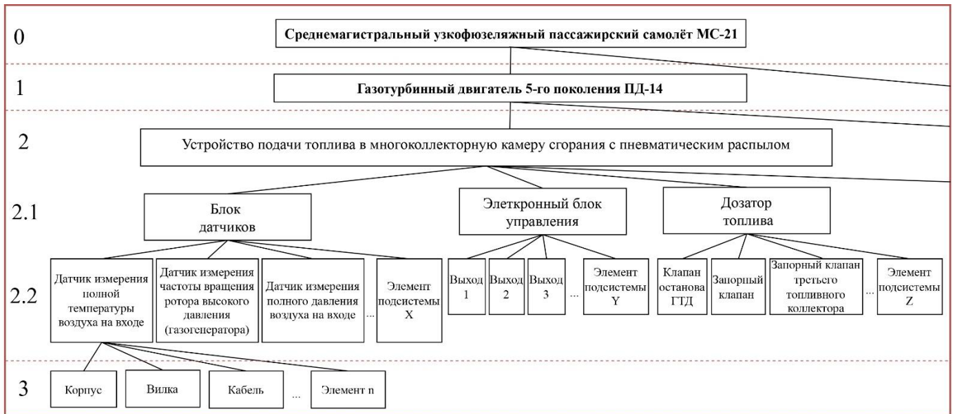
Рис. 8. Пример фрагмента системной декомпозиции сложного технического объекта [14]
