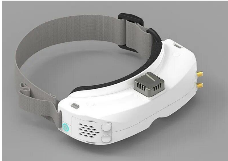
Рис. 6. Аналоговые очки приема видеосигнала
