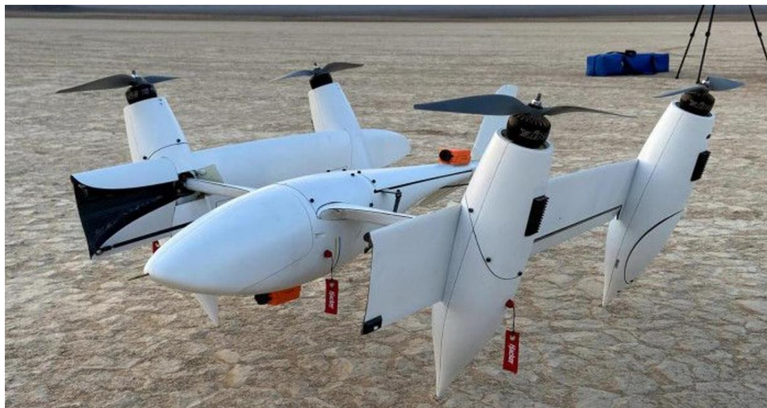
Рис. 4. БАС со складывающимся крылом
