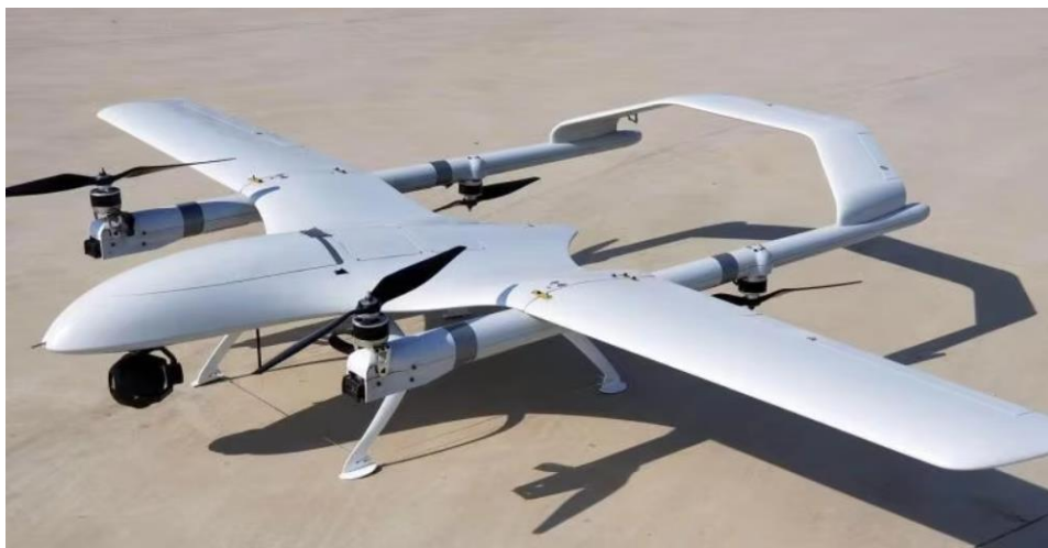
Рис. 3. БАС с поворачивающимися передними моторами
