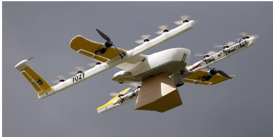
Рис. 2. Гибрид самолётной и мультироторной БАС
