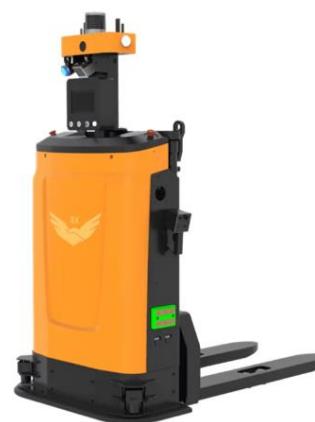
Рис. 3. Вилочный погрузчик с противовесом и автоматическим управлением для работы на открытых площадках
