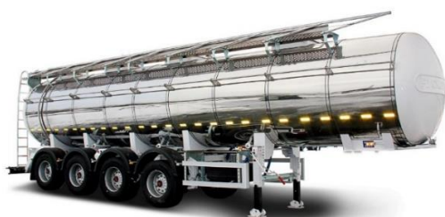
Рис. 2. Полуприцеп-цистерна 33 м 3 для химических жидкостей [10]
