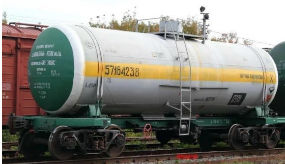
Рис. 4. Цистерна для слабой азотной кислоты модель 15-1487-01 [13].
