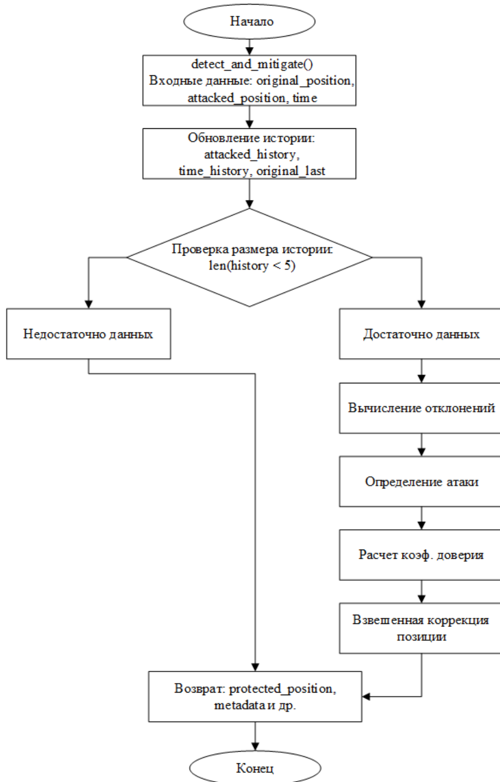
Рис. 3. Алгоритм адаптивного обнаружения аномалий
