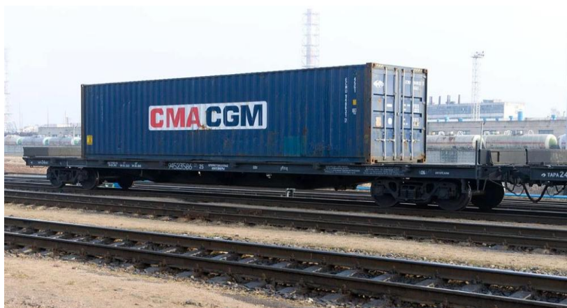
Рис. 4. Фитинговая платформа модели 13-935А-04
